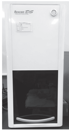
図3 歯型彫刻の計測に使用した非接触式三次元計測装置 (RexcanDS)
